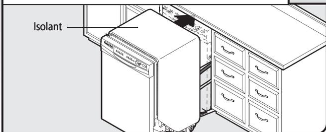
**IMPORTANT :** Si les roues ont été enlevées, recouvrir le sol durant le déplacement du lave-vaisselle. Insérer (lentement) complètement le lave-vaisselle dans la cavité d'encastement. Veiller à ne pas déformer/écraser ou coincer le conduit d'arrivée d'eau, le tuyau d'évacuation ou le câble d'alimentation entre le lave-vaisselle et un placard. Retirer la feuille de carton qui avait été placée sous le lave-vaisselle.
